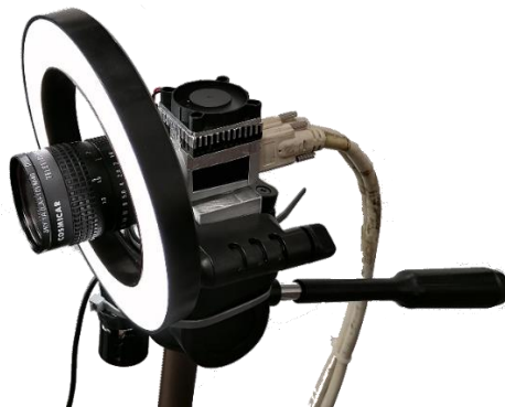
Figura 28 - Montagem da câmara de alta velocidade
