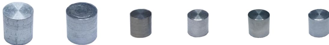
Figura 33 - Provetes cilíndricos tipo de cada material ensaiado, da esquerda para a direita: (i) AA 1050-O, (ii) AA 5083-H111, (iii) AISI 1045, (iv) Maraging 300 convencional, (v) Maraging 300 vertical e (vi) Maraging 300 horizontal.
