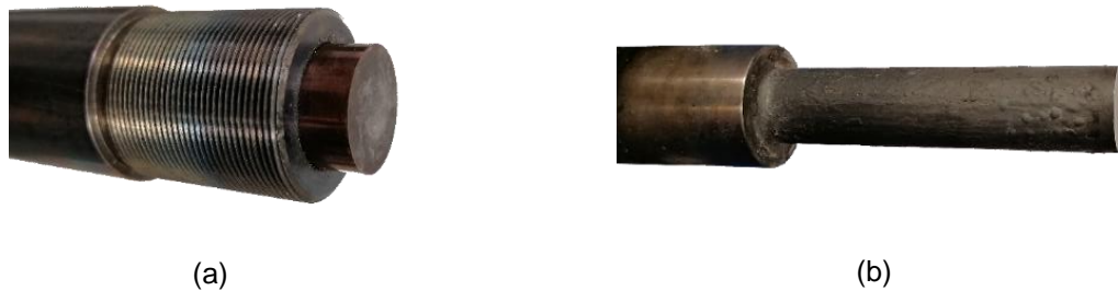
Figura 12 – (a) Extremidade da barra incidente com haste compressora de 10 mm; (b) Extremidade da barra incidente com haste compressora de 80 mm
